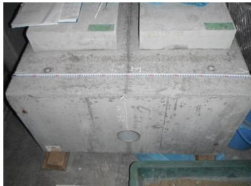
写真 4 RC 床版・厚鋼電線管  $\phi 113.4 \text{ mm}$ 供試体
