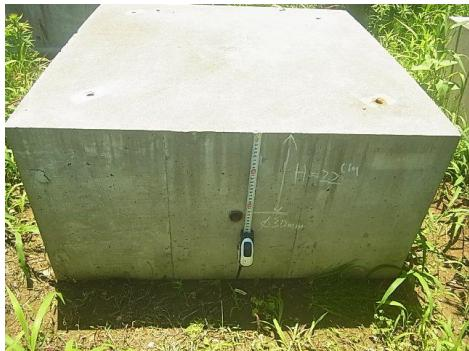
写真 5 RC 床版・厚鋼電線管  $\phi 33.3 \text{ mm}$  供試体
