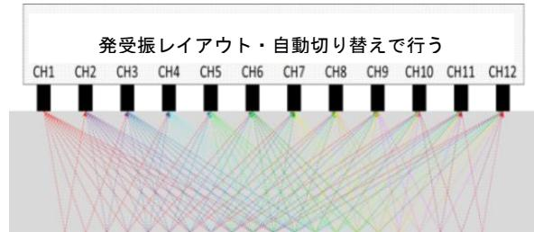
図1 48個のアレイセンサによる探査原理
