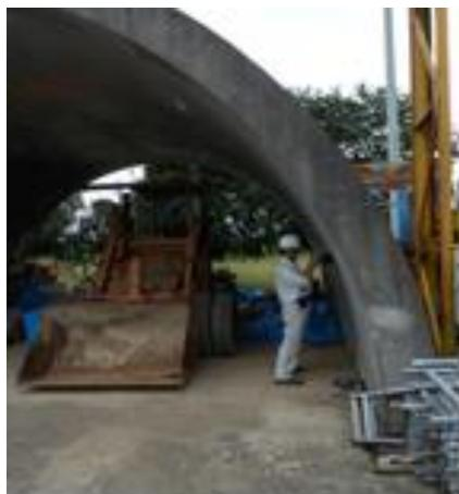
写真 6 側壁部・覆工コンクリート探査の探査
