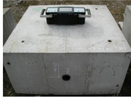
写真 3 RC 床版（ポリエチレン電線管 φ65 mm）供試体
