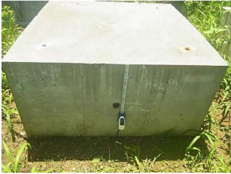
写真5 RC床版・厚鋼電線管φ33.3mm供試体
