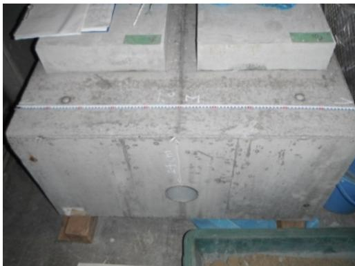
写真4 RC床版・厚鋼電線管φ113.4 mm供試体
