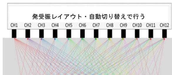
図1 48個のアレイセンサーによる探査原理
