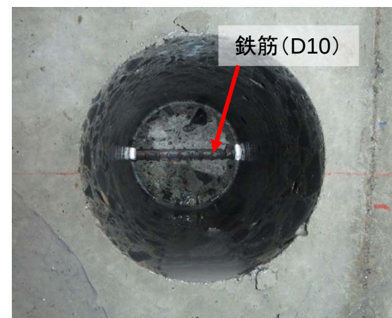
コア採取後の内部(梁モデル)
